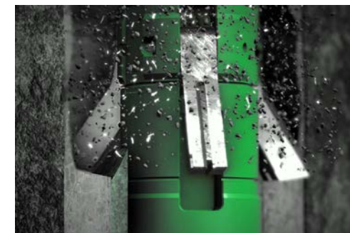
Гидравлические труборезы системы ProLATCH надежны в работе. Они прорезают колонну изнутри, оставляя предсказуемый след среза.
