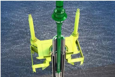
O revestimento é cortado mecanicamente e a lança da cabeça do poço permanece engatada para uma recuperação simultânea da seção do revestimento e da cabeça do poço.
