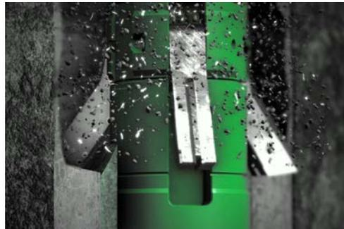
Cortadores de tubos hidráulicos robustos cortam a coluna do revestimento internamente, criando um corte confiável.
