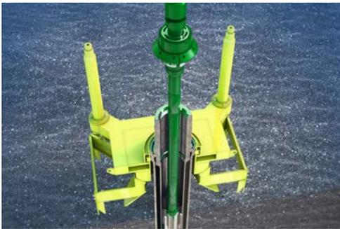
El casing se corta mecánicamente, y el sistema de enganche permanece activa para una recuperación simultánea de la sección del casing y el cabezal.
