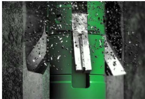
Cortadores de tubos hidráulicos y robustos, cortan el casing internamente, creando un corte confiable.
